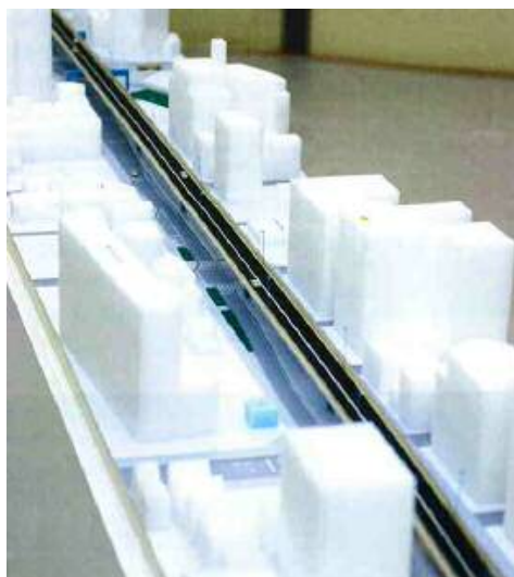
図 8-5 橋梁モデルからの模型作成 (3次元プリンタを使用)
